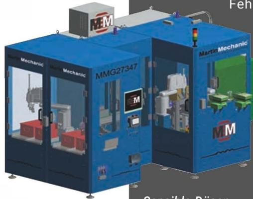
*Sensible Düsen für die Luftfahrt-industrie werden mit der neuen Anlage MMG27347 von MartinMechanic automatisch verschweißt.*
